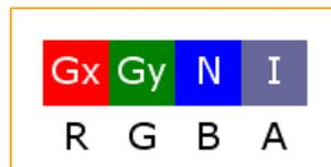
FIG. 2.4 – Illustration de l'encodage des primitives dans un pixel RGBA
